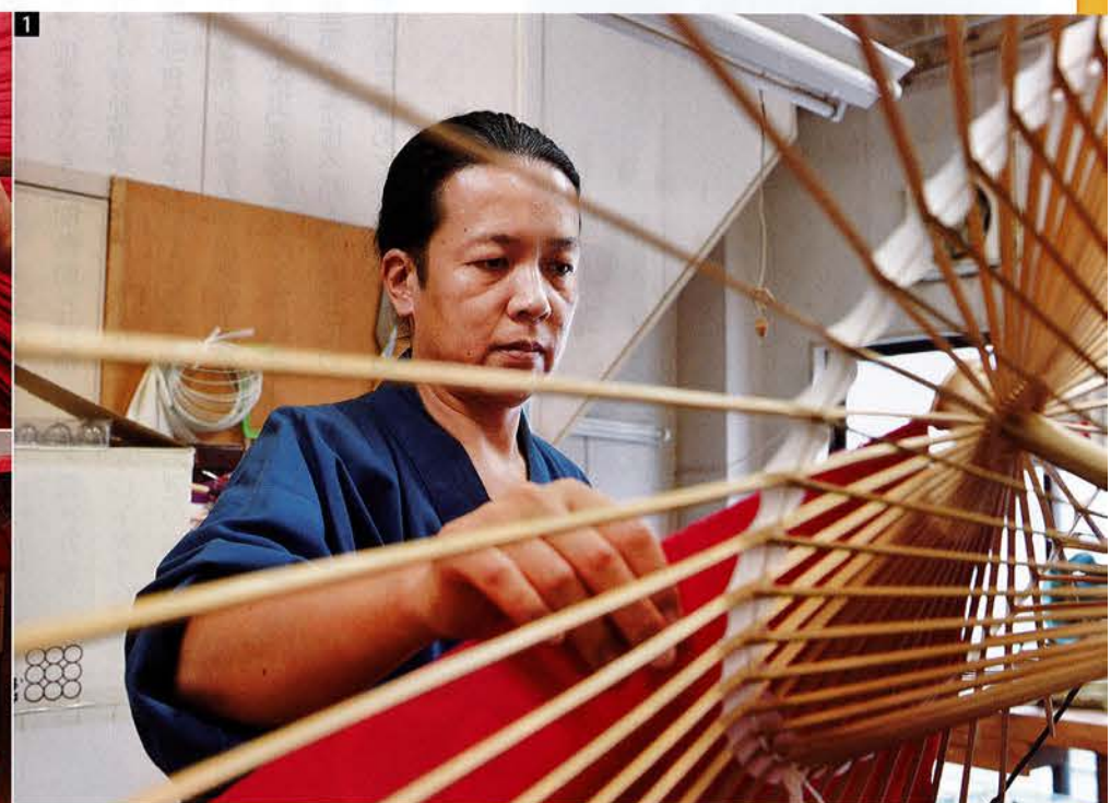
1 竹の骨に手作業で丁寧に和紙を貼っていく製造工程。160年続いた伝統の技だ。 2 専用の道具で一筋一筋、和紙を骨に接着していく。和傘市場の衰退で道具の作り手もいなくなり、現在は道具も自社内で作っている。3 株式会社日吉屋代表取締役社長の西堀耕太郎氏。老舗の技を活用し、新しい市場の開拓に成功した
