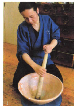
1. 和紙を貼る糊を調合する西堀さん。糊の原料は戦後にワラビ粉からタピオカ粉に変わったが、使う分だけ調合する手間は変わらない。2. 江戸時代から受け継がれたものもある。年季の入った道具類。3. 手元紙を竹骨に貼っていく工程では、又べらという専用の道具を用いる。4. 防水のための亜麻仁油を塗る西堀さん。亜麻仁油は一晩かけて和紙全体に染みこんでいく。5. 傘の開閉を可能にする木製の口クロ。この部品を制作する工房も全国で一軒だけになってしまったそう。6. 和傘の骨組みには、岐阜の真竹が使われている。7. 蛇の目傘などに用いられる飾り糸は、傘の内側を華やかに演出する。
