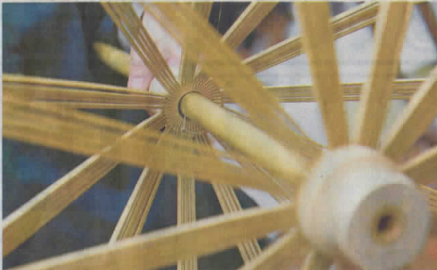
④「手元ロクロ」(奥)と「天ロクロ」(右手前)は和傘の重要な材料だ ⑤「下事」と呼ばれる骨組みの作業で、小骨と親骨を接続する
