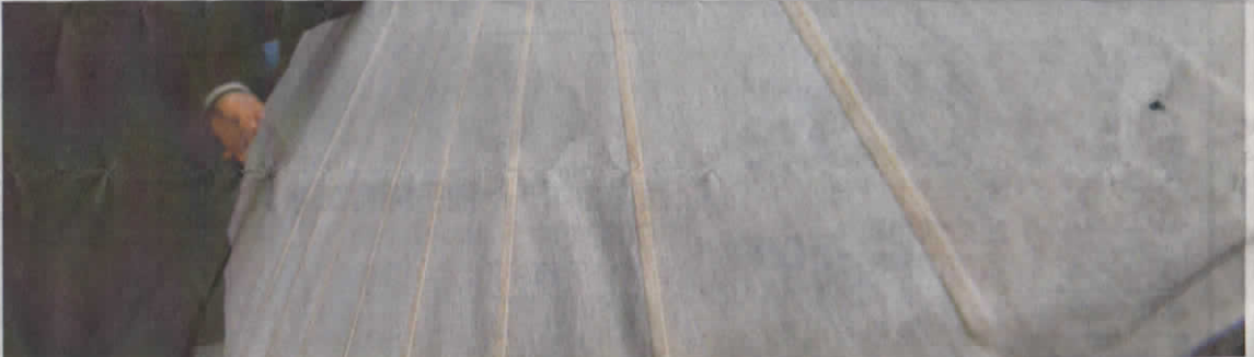
「またべら」という道具を使い、和傘の胴張りをする。独自開発した和紙調ポリエステル生地は骨の形が浮かび上がった＝いずれも京都市上京区の「京和傘 日吉屋」で、小松雄介撮影
