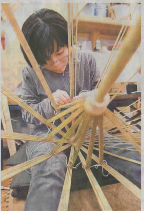
④「手元ロクロ」(奥)と「天ロクロ」(右手前)は和傘の重要な材料だ ⑤「下事」と呼ばれる骨組みの作業で、小骨と親骨を接続する
