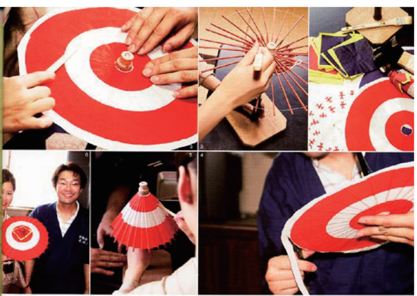
〔右ページ〕1.直径30cmほどのミニ和傘作りが体験できる。サイズこそ小さいが、材料は本格的。季節のしつらいに飾るほか、贈り物として贈るキットも別売している。2.傘の骨にのりを塗る。3.紙を貼り、骨の間の隙間がないように、ヘラで押しつけていく。4.余分な紙を切る。5.和紙に折り目を付ける。ひとつひとつが手仕事だ。6.出来上がり。専用の布袋と箱が用意されているので、お土産にも喜ばれそう。7.1階の店では、こんな強い和傘も買える。8.和傘の骨組みは1本の竹を何十本にも縦向きに刺したものだ。だから開いたときにきれいに収まるのだ。(左ページ)西塚琢太郎さんは、真縁の実家を継ぐ形でこの世界に入っておよそ30年。革新的なデザインに代わって60年にわたってのれんを守り続けた経験に、昨年、後を任された。「伝統は守るだけではなく、今の時代に合わせて進化しなければ」と、和傘の技術を生かした新商品の開発や、後進の育成にも意欲を熱やす。
