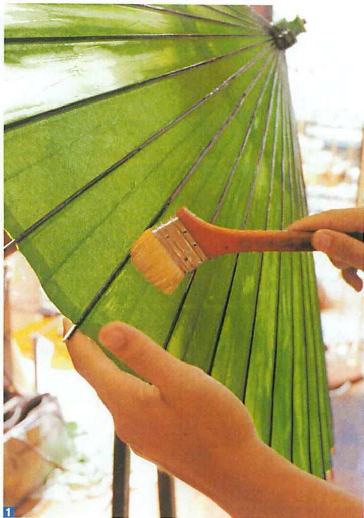
1 防水の必要のある和傘の表面に亜麻仁油を塗る。そのあと天日で数日〜2週間程度干す。店の向かいのお寺の境内で天日干しすることも。2 骨組みの準備。親骨、小骨は細く割いた竹に糸を通すための穴などが開けられて下処理されている。3 傘骨の本数に合わせて溝が彫られているロク口に竹骨を差し込み、開閉できる骨組みを作る。4 親骨と小骨の穴を合わせ、糸をよりながら結びつける。5 型紙に合わせて和紙を裁断し、タビオカ粉を原料としたのりで和紙を張り付けていく。6 姿付け。張り終わった傘を乾燥させ、渦巻き状に折り畳めるように手と工具で折り目をつける。7 野点傘や蛇の目傘などには、小骨の周囲に色とりどりの飾り糸を施し、傘の先端の「かっぱ」などを取り付けて完成となる
