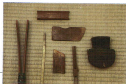
和傘造りの道具。左に見えるふたまたの道具は「胴張り」。骨の上に貼った和紙を抑える道具である。2代目から使っているというから、おそらく150年以上前のものだろう。
