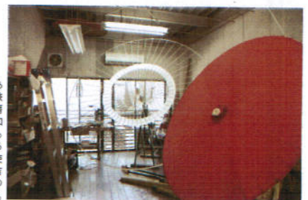
和傘造りの道具。左に見えるふたまたの道具は「胴張り」。骨の上に貼った和紙を抑える道具である。2代目から使っているというから、おそらく150年以上前のものだろう。
