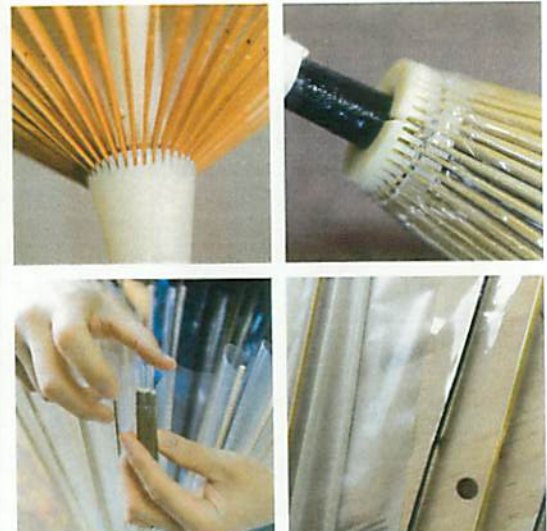
上の2枚 樹脂でつくられたWAGASAのロクロ。切り込んだ溝からワイヤーを水平に通し、骨をつなげている。天ロクロの上には、和傘のから巻き(35頁参照)に相当する可動部品があって、開閉にかかる力を吸収する。下右は試作で使った半透明のタイプと、採用されたEVA+PPの三層構造特殊フィルム。(右側の透明なもの)。この特殊フィルムは環境負荷が軽く、折グセがきれいに付く
