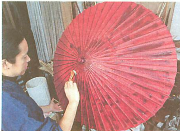
店舗2階の工房で、和傘を作る西堀さん。刷毛(はけ)で油を塗るなどの作業は、骨の間隔をそろえるため、傘を全開状態にして行う
